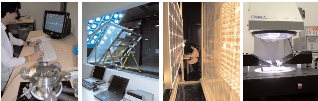
Algunos instrumentos del laboratorio de energía solar fotovoltaica del CENER: de izquierda a derecha espectroscopio DLTS de niveles profundos y tres simuladores solares para ensayos de captadores térmicos y células y módulos fotovoltaicos.
