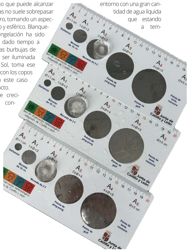
Figura 1: Regla utilizada para observar con realismo los tamaños de las piedras de granizo precipitadas. Se ve que en la parte mas externa es transparente a diferencia de la parte central que es mas blanquecina. Señal de que el crecimiento ha sido por vía húmeda
