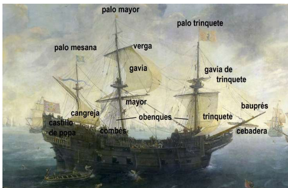
Figura 2. Galeón español del cuadro “The Spanish Armada off the English coast” de C.C. van Wieringen, (Rijksmuseum Amsterdam). Sobre él se han superpuesto nombres de partes del buque
