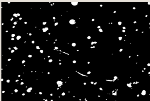
Placa de un granizómetro en la que se pueden apreciar los impactos producidos por el granizo
