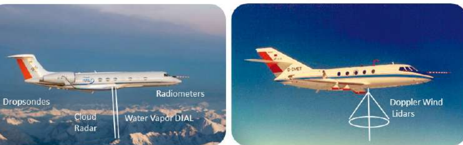
Figura 1. HALO y Falcon con instrumentos de NAWDX. Imagen tomada de la página web del proyecto
