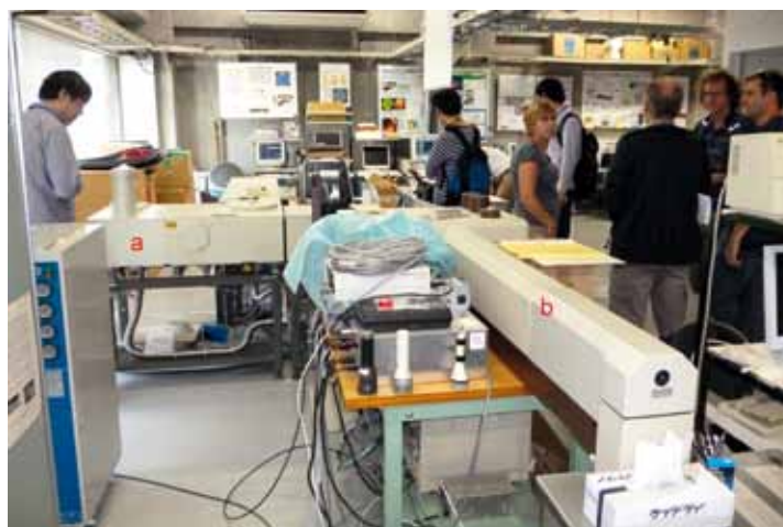
Visita a la estación NDACC-IRWG de Rikubetsu, donde se localizan dos sistemas FTIR (a) IFS 125HR y (b) IFS 120M.
