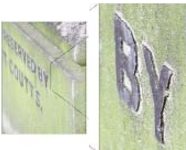
Detalle de parte de la inscripción de una lápida donde se aprecia el desgaste de la piedra.
