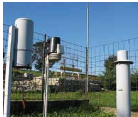
Pluviómetros (a la izquierda) y pluviógrafo (derecha) de la estación meteorológica de Ojaiz-Peñacastillo (Cantabria), en las cercanías de Santander. Crédito: José Luis Pelayo.
