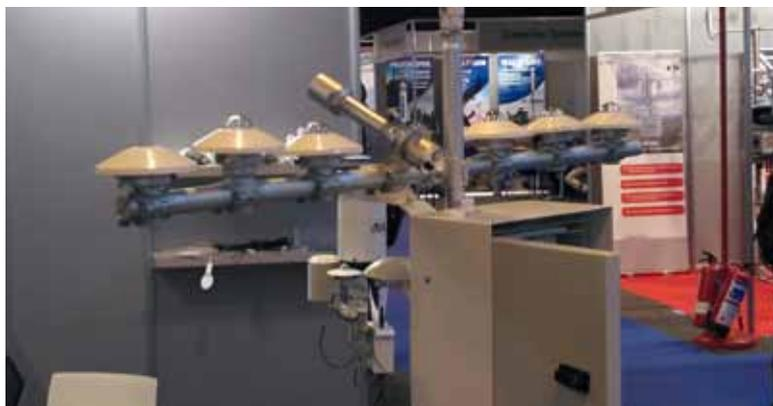
Muestrario de sensores de radiación solar con fácil anclaje al soporte mediante bisagra
