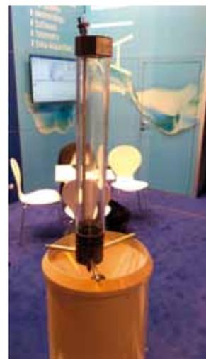
Sistema de calibración para pluviómetros
