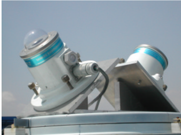
Figura 1.- Dispositivo experimental para la medida de la radiación UVB sobre planos inclinados.
