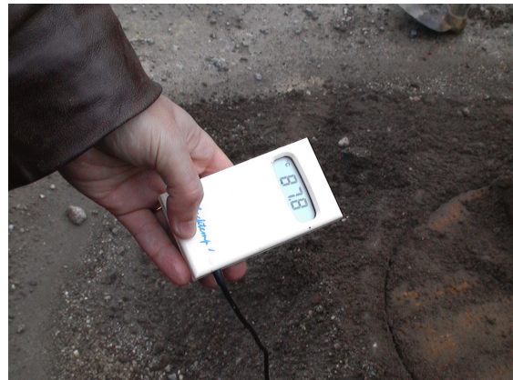
Fig. 18. – Temperatura à superfície – tampa (87,8 °C)
