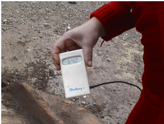
Fig. 20. – Temperatura no forno – após abertura (64,2 °C)
